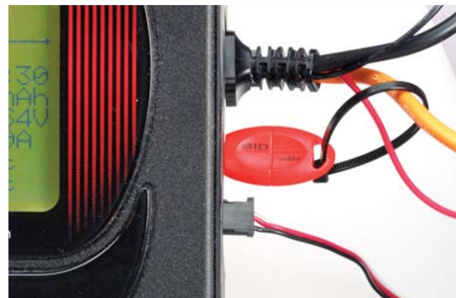
Der Bid-Key wurde per Kabelbinder an einem Stromkabel des Akku-Packs befestigt
