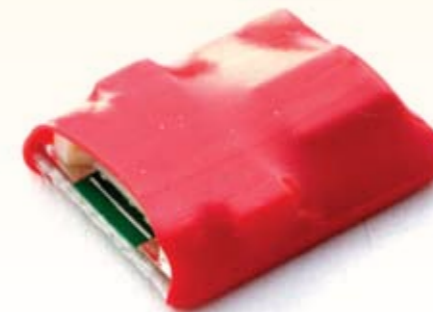
Im Schrumpfschlauch eingeschlossener Bid-Chip mit einem Fliegengewicht von weniger als einem Gramm
