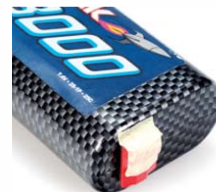
Die Steckkontakte des Bid-Chip sollten geschützt werden, insbesondere wenn der Akku während des Einsatzes Staub und Schmutz ausgesetzt ist
